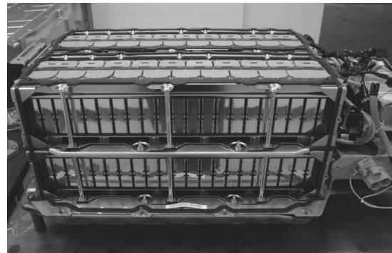
(d) Internal configuration of C-MAX Energi battery pack
